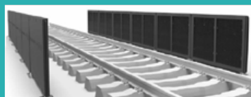
Écran bas proche des voies fait de panneaux légers
