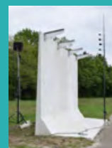
Écran en béton en forme de L
